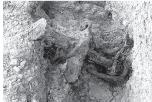
Εικ. 23 Ο σιδερένιος πύρος και τα εξαρτήματα σύνδεσης ρυμού- εμπρόσθιου άξονα στην άμαξα.
